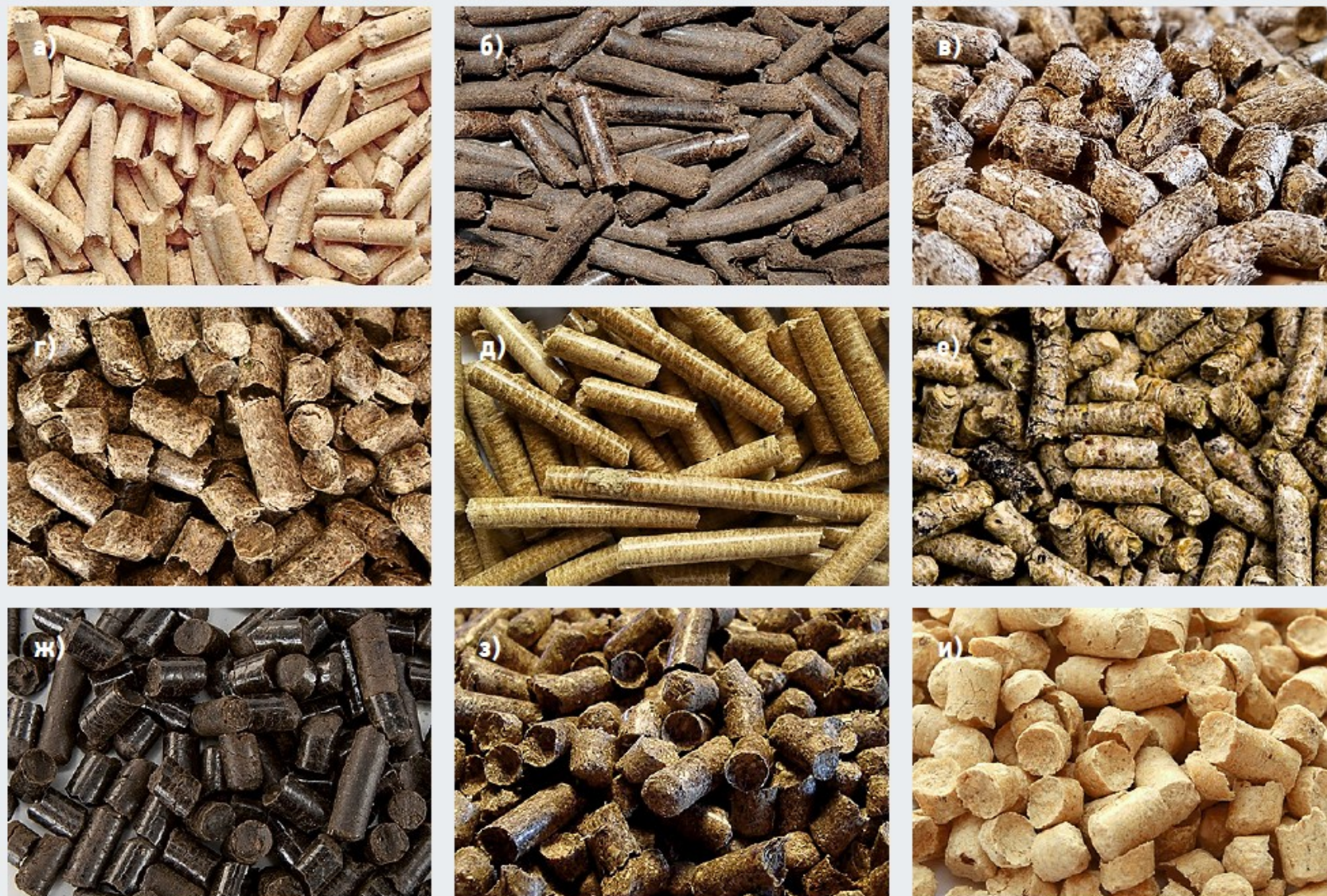
❖❖ Рис. 4. Виды пеллет [изготовленных из: а — древесных опилок берёзы; б — гречневой шелухи; в — стеблей рапса; г — ржи (соломы); д — рисовой шелухи; е — шелухи семечек подсолнуха; ж — торфа; з — ячменя (соломы); и — древесных опилок сосны]
